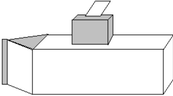
**Boot mit Luft** betrieben: Grundplatte auf der ein Durchbohrter Besenstiel als Schornstein befestigt wurde. Durch die Bohrung wurde ein knickbarer Strohhalm gesteckt, der dann unter dem Boot als Antrieb lag. Oben auf den "Schornstein" wurde ein Luftballon gemacht, der die Luft durch den Strohhalm trieb. In einem Planschbecken ließen wir die Boote fahren. (Bukimo: Pfingsten, © Bukimoteam Groß Elbe )
